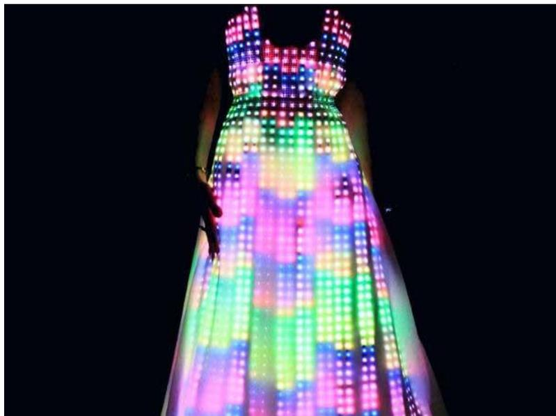
*Trame a Led controllabili mediante smartphone. Progetto CuteCircuit*
